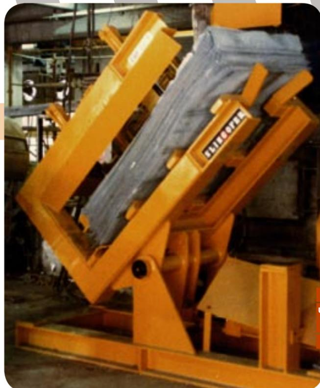
**I** Ribaltatore fisso idraulico per pacchi mod. RFMOP
