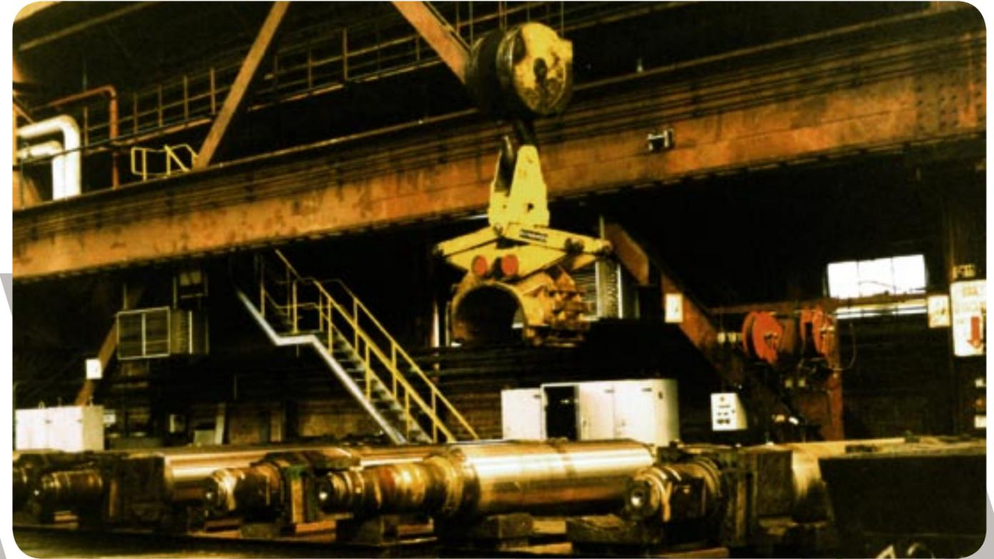
**I** Pinza automatica meccanica per cilindri singoli senza guarniture
