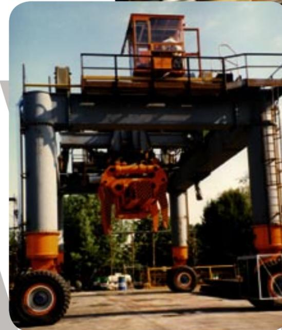
**I** Pinza a stretta idraulica per bramme con tastatore
