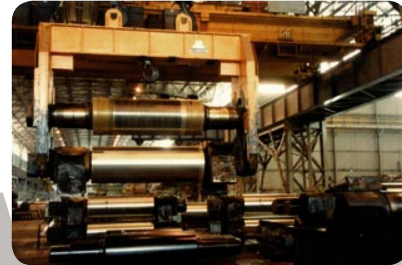
**I Pinza elettroidraulica per cilindri di lavoro singoli e/o in coppia con/senza guarniture**
