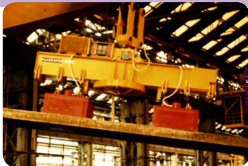
**I** Traversa rotante con magneti
