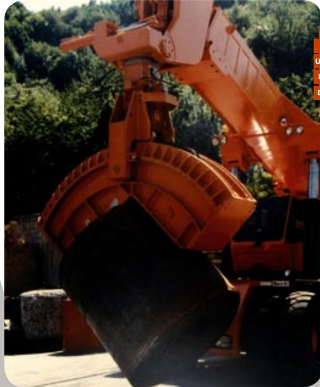
**I** Ribaltatore aereo per coils tipo 735 montato su autogru
