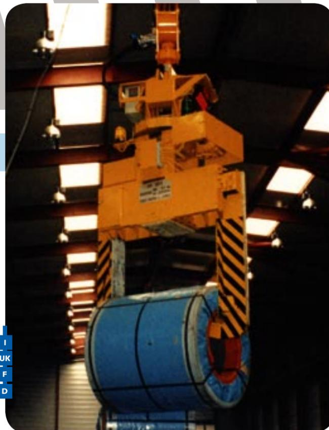
**I** Pinza per coils motorizzata con pesatura tipo 726
