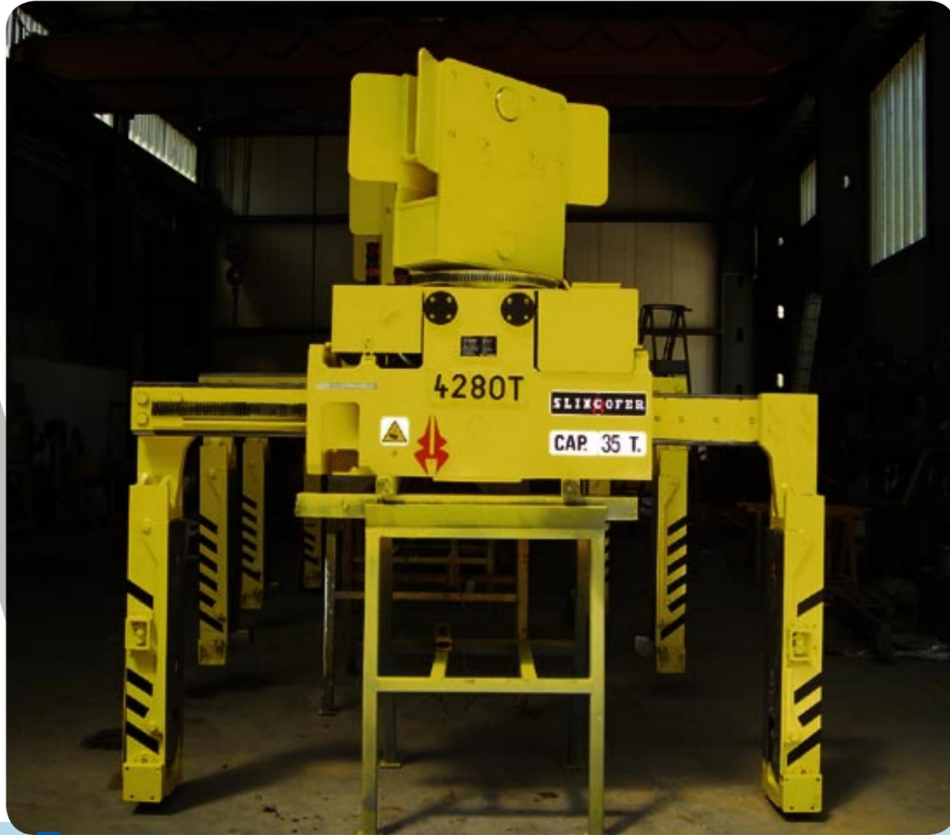
**I** Pinza per coils motorizzata tipo 726 con piedini ribaltabili
