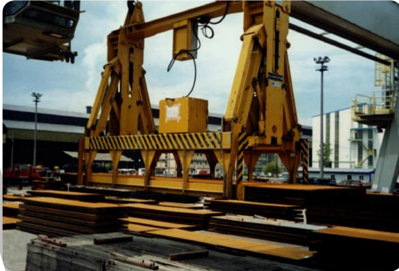
**I** Pinza per pacchi elettroidraulica mod. 727P
