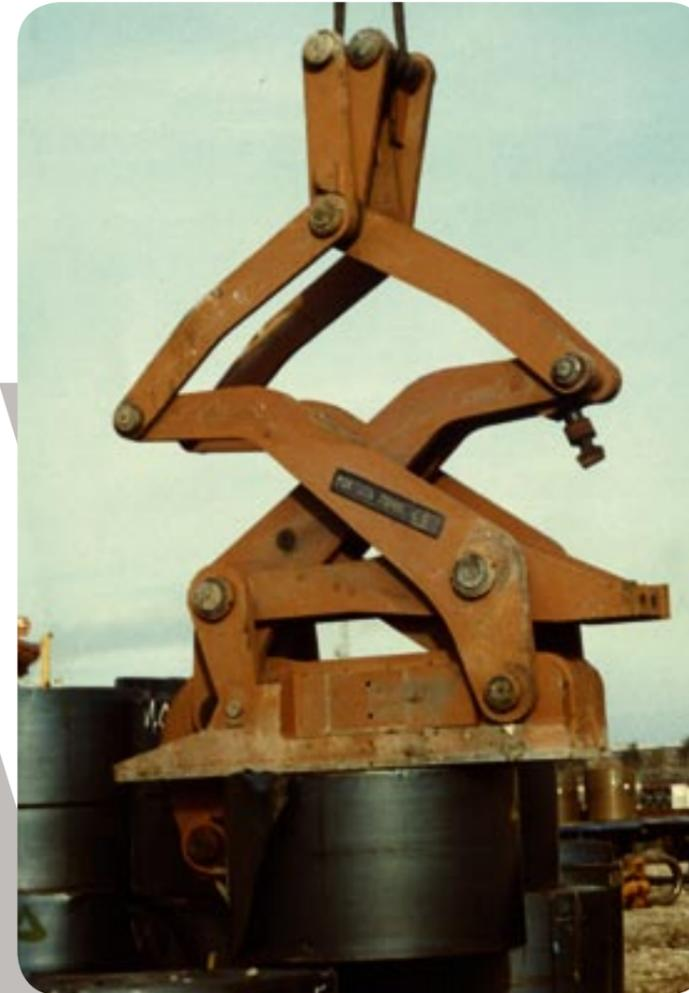
**I** Pinza automatica meccanica per coils neri ad asse verticale tipo 724
