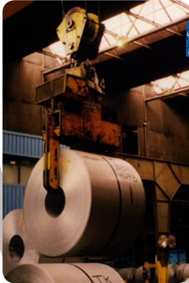
**I** Pinza per coils motorizzata tipo 726 con testa girevole
