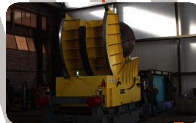
**Ribaltatore fisso motorizzato per coils mod. RFM**
