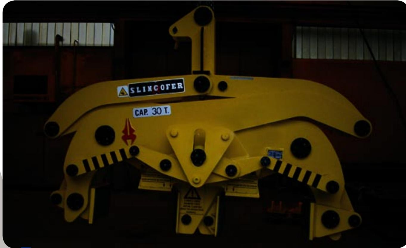
**I** Pinza automatica meccanica per coils ad asse verticale (presa interna ed esterna) tipo 724D
