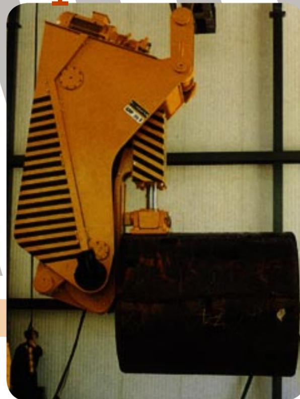
**I** Ribaltatore aereo idraulico per coils tipo 725
