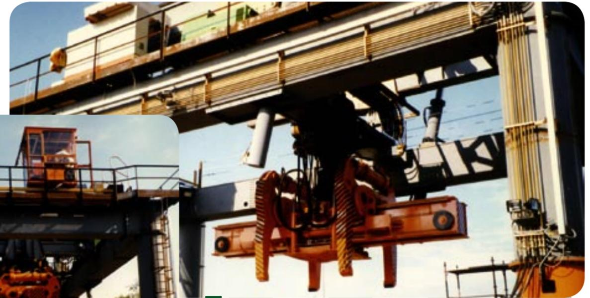
**I** Pinza motorizzata per bramme con argano ausiliario del carro ponte
