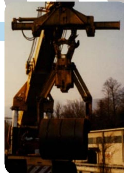
**I** Pinza per coils elettroidraulica montata su autogrù tipo 727
