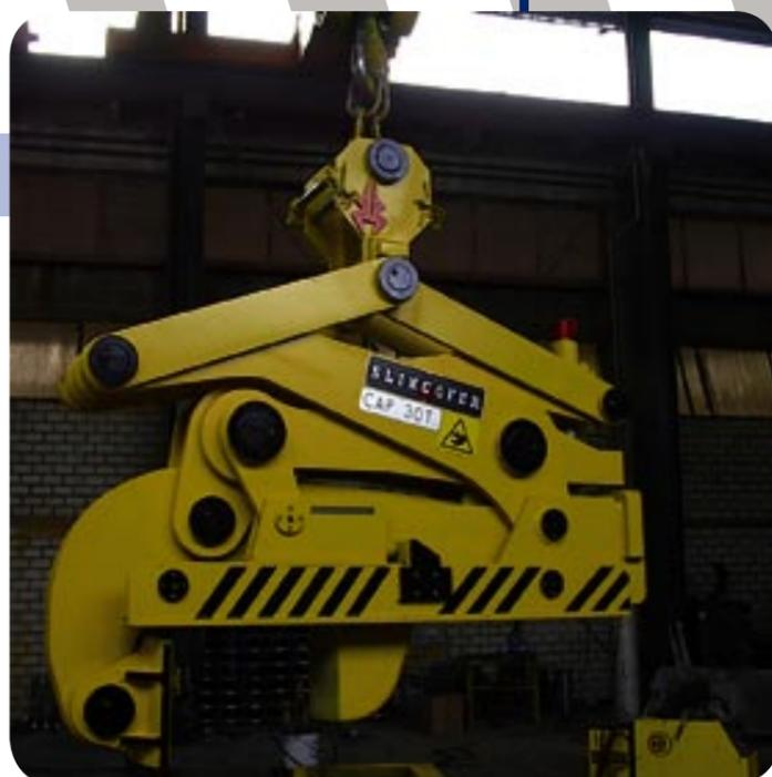
**I** Pinza automatica meccanica per coils finiti ad asse verticale tipo 724 con antistrisciamento ed indicatore posizione nottolino
