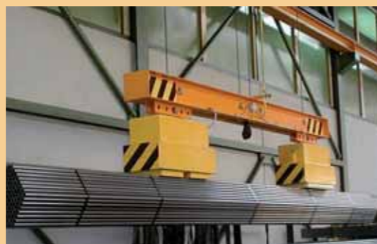
Traversa con elettromagneti a campo profondo per pacchi esagonali di tubi 4÷6 mt, 3T
