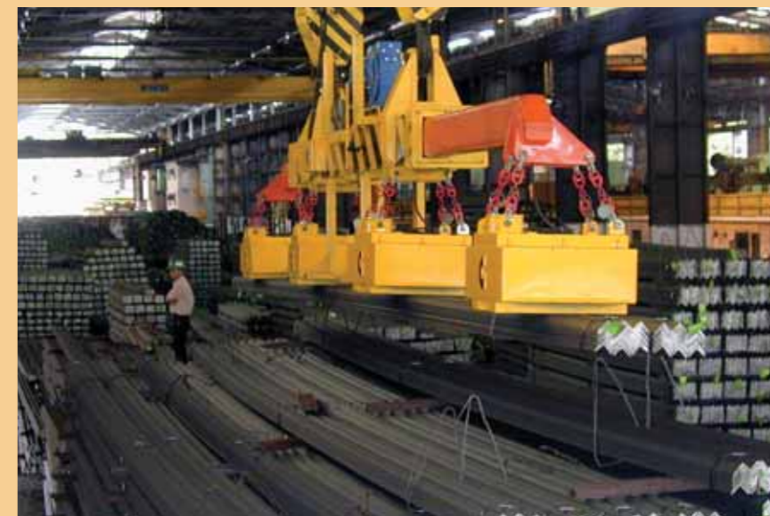
Traversa estensibile motorizzata con elettromagneti a campo profondo per fasci angolari 6÷12mt, 8T
