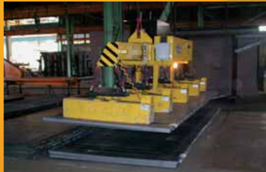
Traversa estensibile motorizzata con elettropermanenti per pacchi di lamiera 3÷8 mt, 6T
