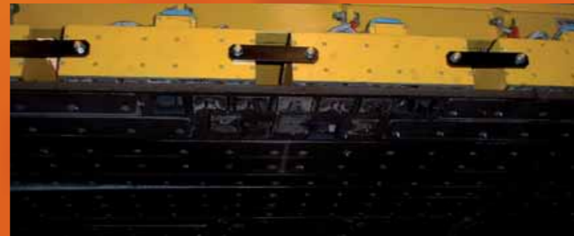
Traversa con elettropermanenti per carico-scarico taglio laser 6 mt, 3T
