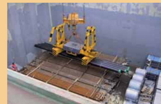
Traversa con forche meccaniche di sicurezza con elettromagneti per strati di tubi 6÷12 mt, 15T
