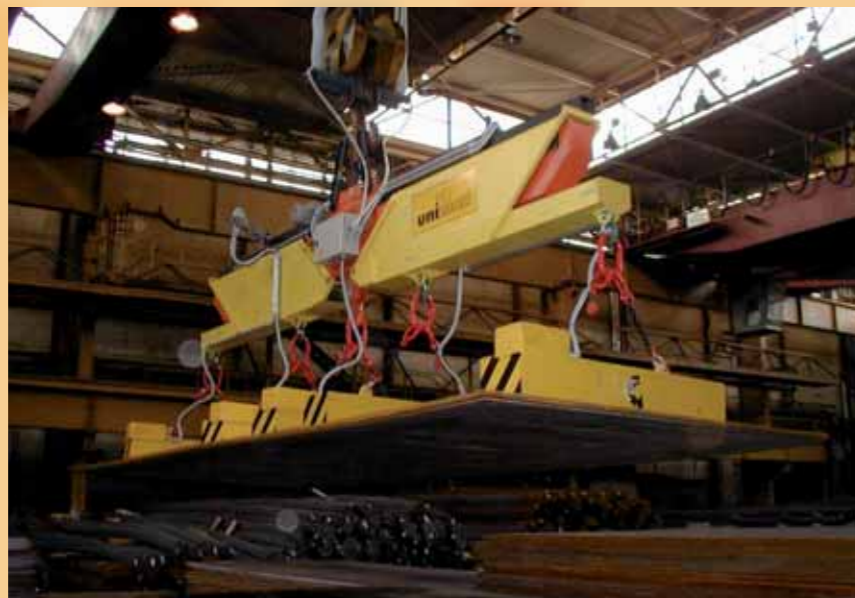
Traversa estensibile motorizzata con elettromagneti per lamiere singole e multiple da 3÷12 mt, 8T
