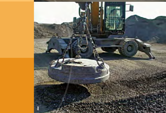
E Elettromagnete circolare ad azionamento idraulico, montato su semovente. Circular electromagnet with hydraulic control, mounted on mobile-crane.
