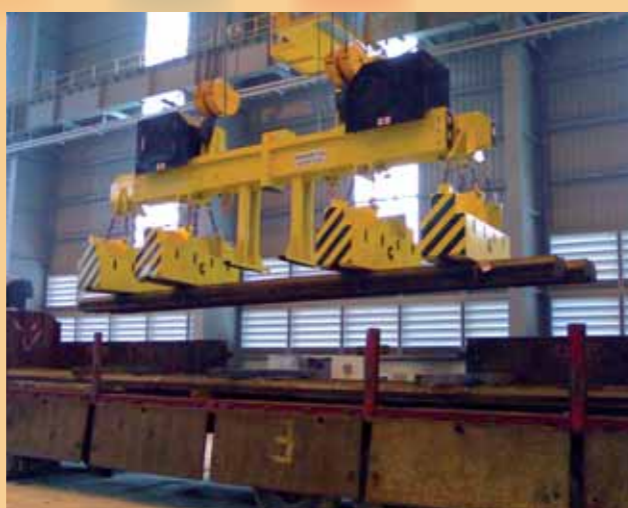
Traversa estensibile motorizzata con elettromagneti a campo profondo per fasci profilati 6÷12mt, 10T
