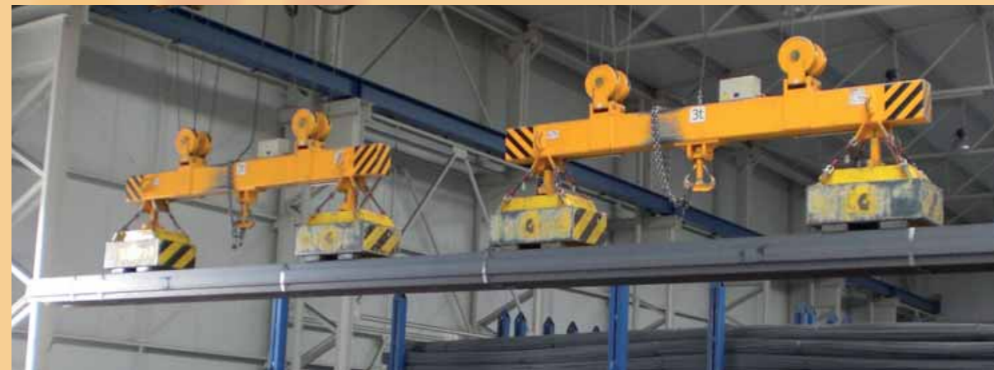
Traversa con elettromagneti a campo profondo per fasci di travi 6÷12 mt, 6T
