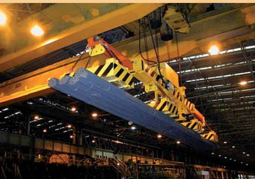
Traversa estensibile motorizzata con elettromagneti a campo profondo per fasci tondino 6÷12mt, 10T
