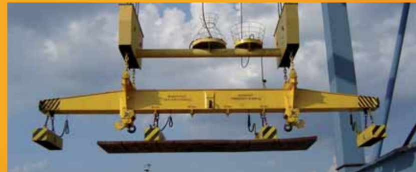
Traversa con elettromagneti per lamiere multiple 6÷12 mt, 12T
