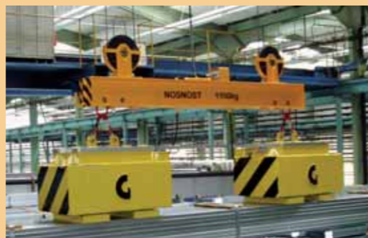
Traversa con elettromagneti a campo profondo per fasci di tubolari 6 mt, 2,5T
