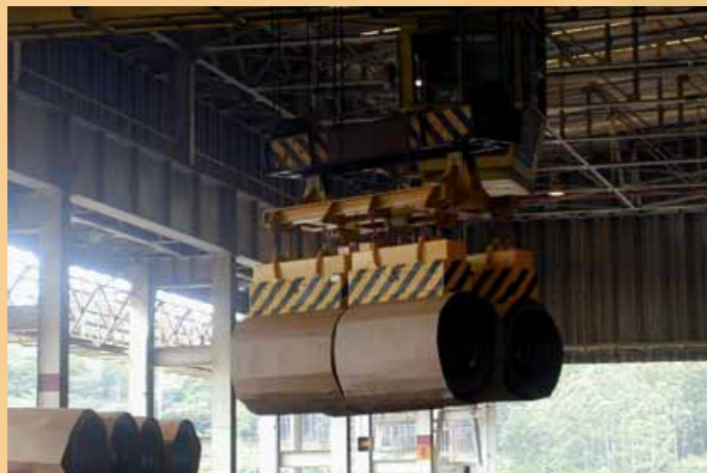
Traversa con 4 elettromagneti a per rotoli vergella Ø 1250x2200 mm, 12T
