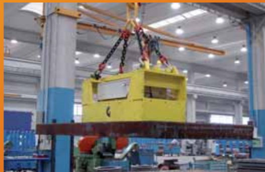
Elettropermanente per movimentazione bramme, 15T
