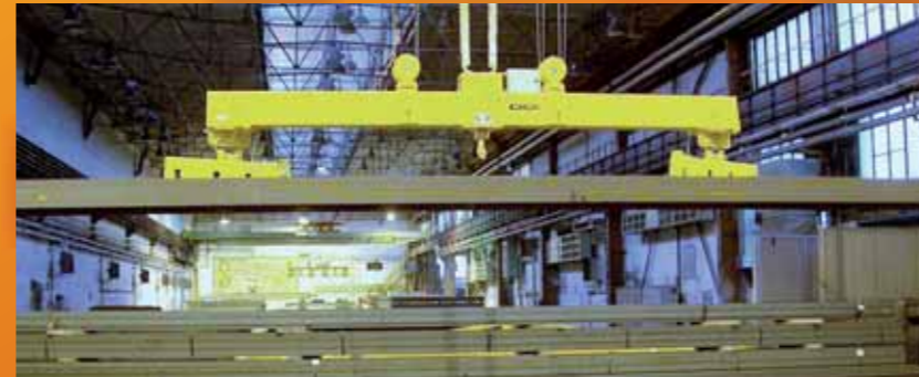
Traversa con elettromagneti per travi singole HEA-HEM da 100÷1000 mm, 18 mt, 7T
