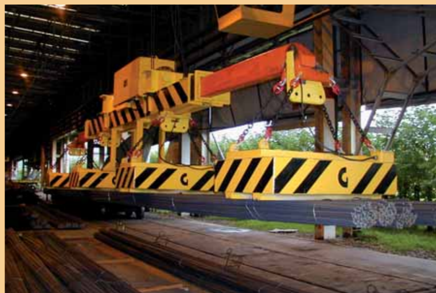
Traversa estensibile motorizzata con elettromagneti a campo profondo per fasci tondino 6÷12mt, 8T
