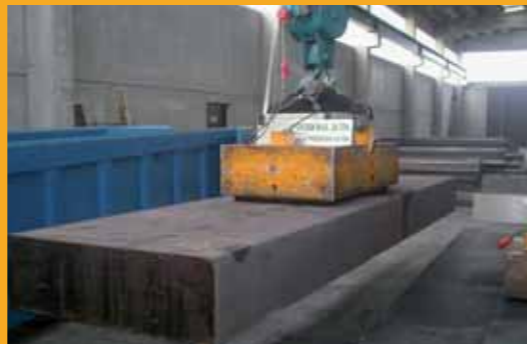
Elettropermanente per movimentazione bramme, 15T
