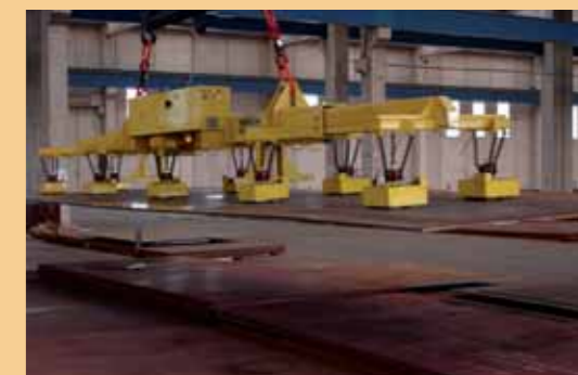
Traversa estensibile motorizzata con elettropermanenti per lamiere da 6÷12 mt, 15T
