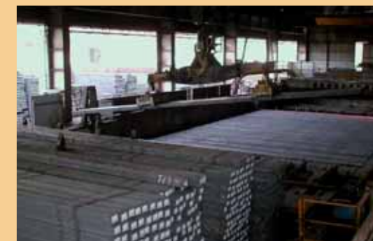
Traversa con elettromagneti per billette a 400°C 6÷12 mt, 12T
