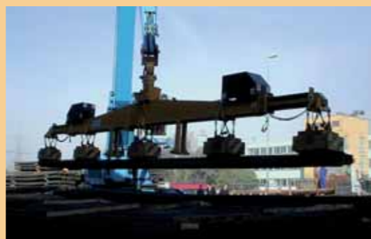
Traversa estensibile motorizzata a comando idraulico con elettromagneti per fasci tondino 12÷16 mt, 5T montata su semovente
