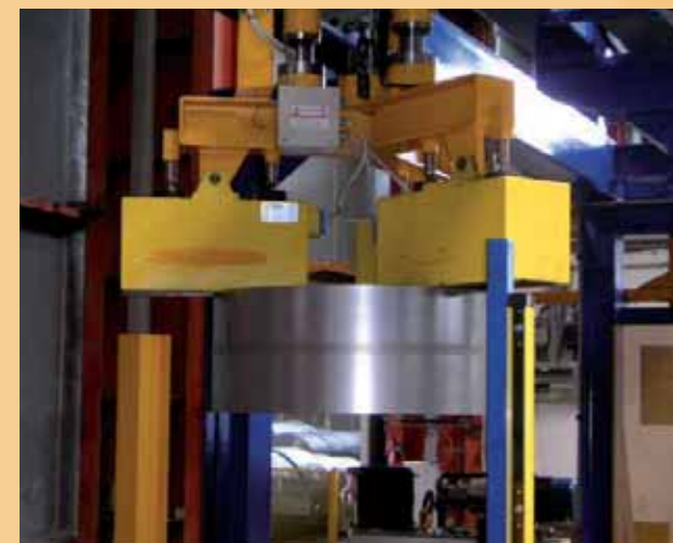
Traversa con elettropermanenti per sollevamento tagli di coils ad asse verticale, 6T
