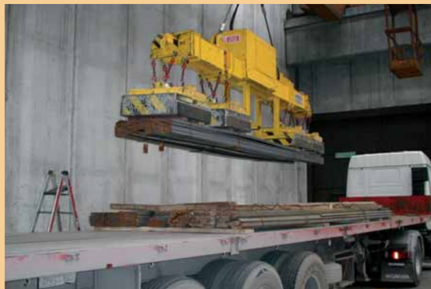
Traversa estensibile motorizzata con elettromagneti a campo profondo per fasci 6÷12mt, 7T
