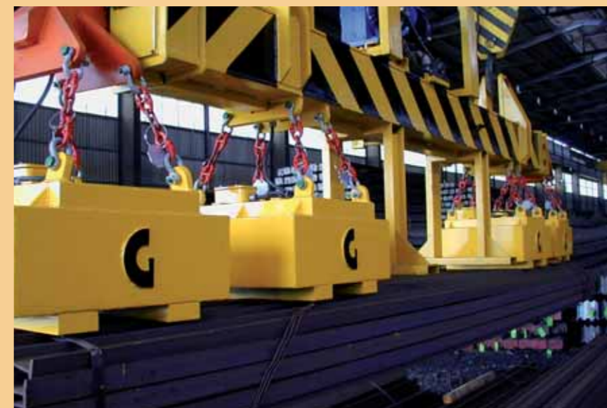
Traversa estensibile motorizzata con elettromagneti a campo profondo per fasci travi 6÷12mt, 8T
