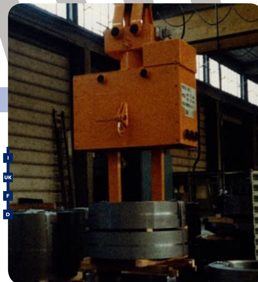
I Pinza motorizzata per coils ad asse verticale su pallets tipo 720
