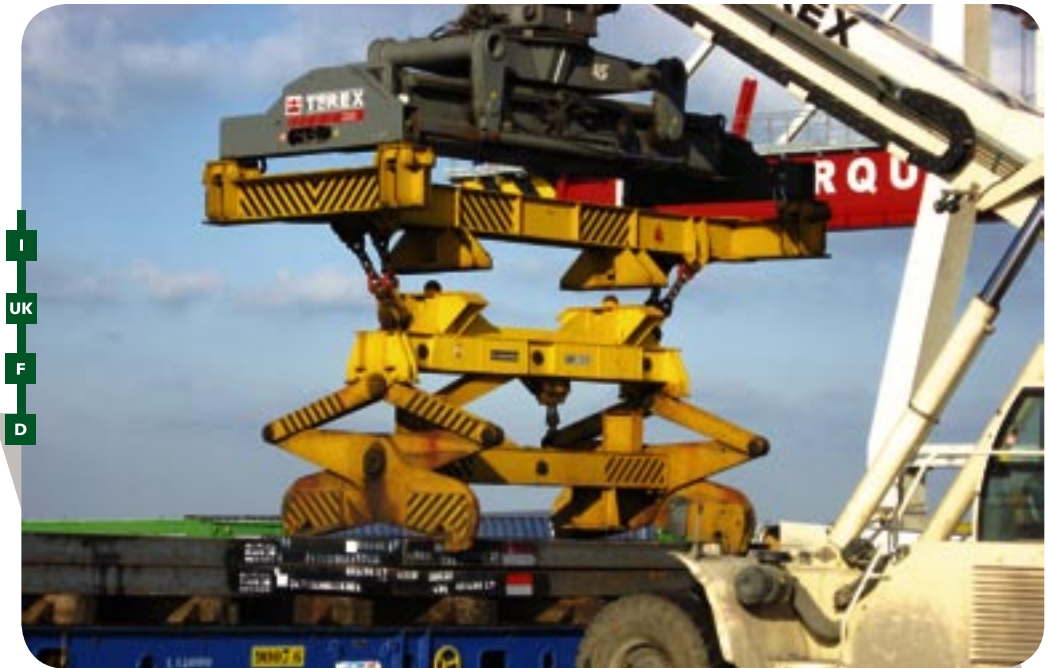
I Pinza automatica meccanica per bramme su autogrù
