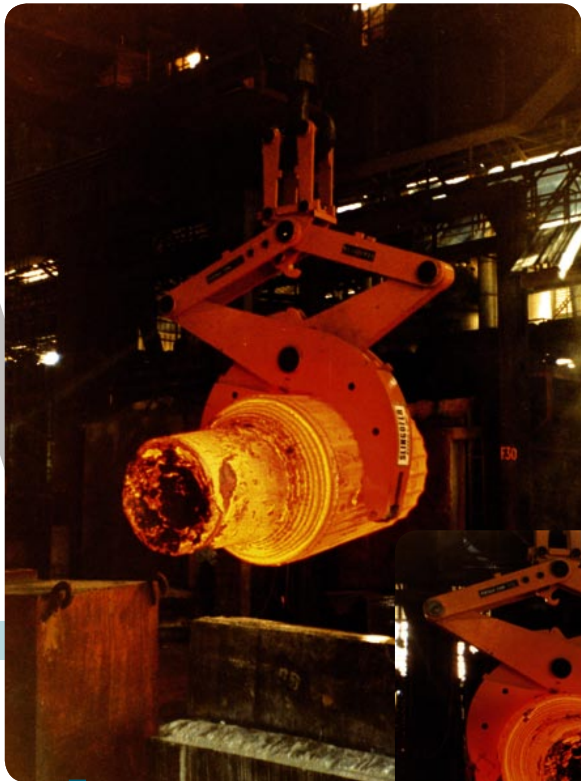
I Pinza automatica per lingotti UK Ingot lifter F Pince à lingots D Blockzange
