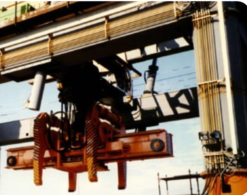
I Pinza a stretta idraulica per bramme con tastatore UK Slabs tong with hydraulic clamping with adjustable table F Pince à brames avec prise hydraulique et palpeur réglable D Brammenzange mit hydraulischem Zangenarmantrieb und Greifweiteneinstellung
