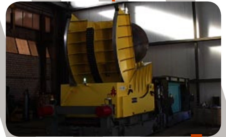
Ribaltatore fisso motorizzato per coils mod. RFM Motorized coil tilter Basculeur fixe motoriste à bobines Coilwendeeinrichtung, motorisch angetrieben
