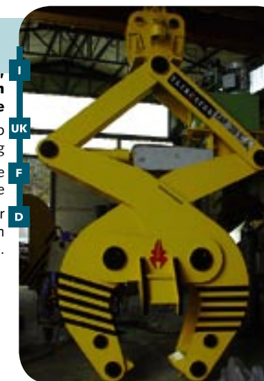
I Pinza motorizzata per lingotti, presa verticale e ribaltamento in orizzontale
