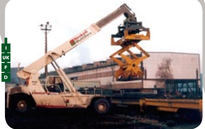
I Pinza automatica motorizzata per bramme su autogrù
