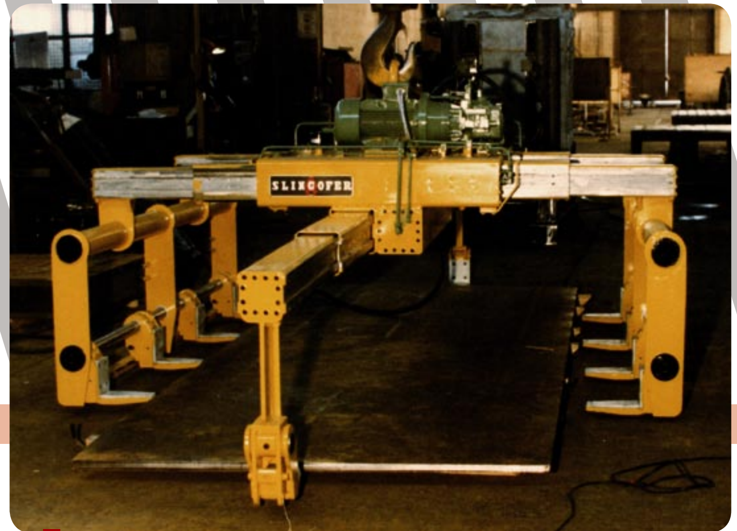
I Pinza per pacchi motorizzata con presa sui 4 lati
