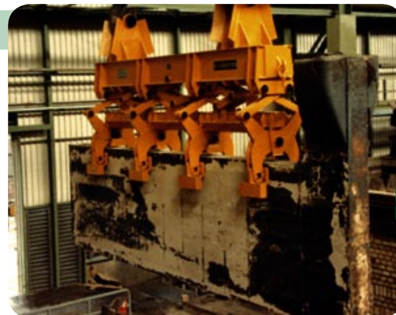
I Pinza meccanica per bramme verticali
