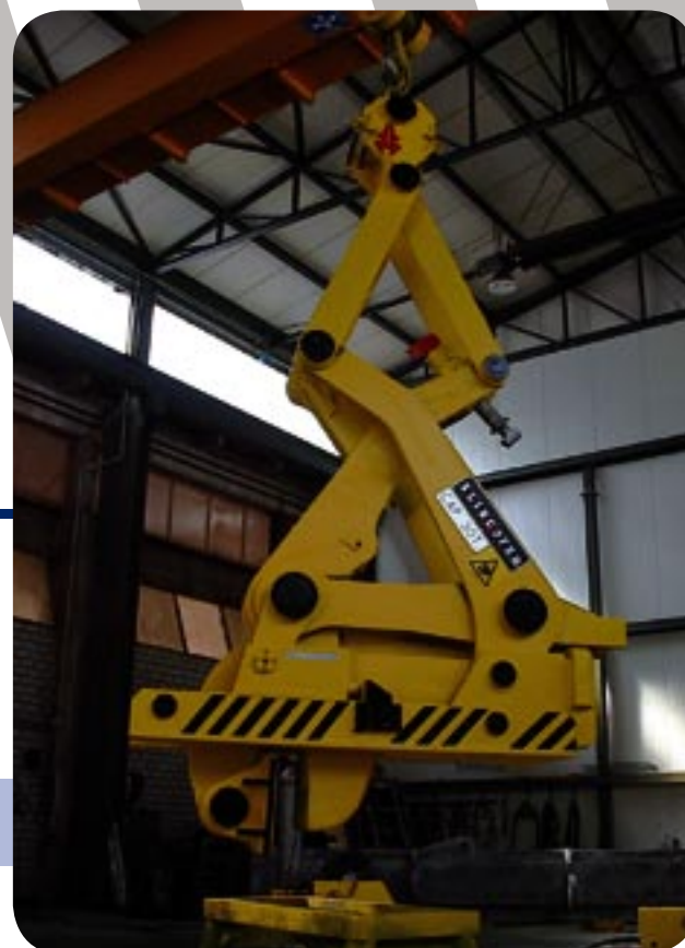
I Pinza automatica meccanica per coils finiti ad asse verticale tipo 724 con antistrisciamento ed indicatore posizione nottolino
