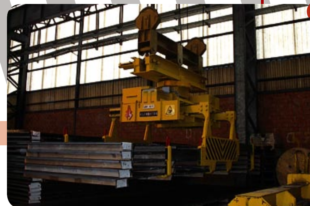
I Pinza per pacchi motorizzata mod. 717 con testa girevole
