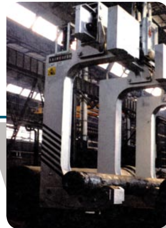
I Traversa motorizzata per lingotti UK Motorized ingots beam F Palonnier motorisée pour lingots D Blocktraverse, motorisch angetrieben
