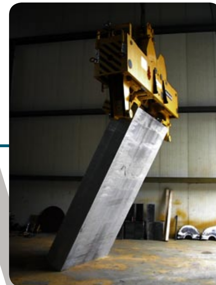
I Pinza automatica meccanica per placche alluminio presa verticale e ribaltamento in orizzontale
