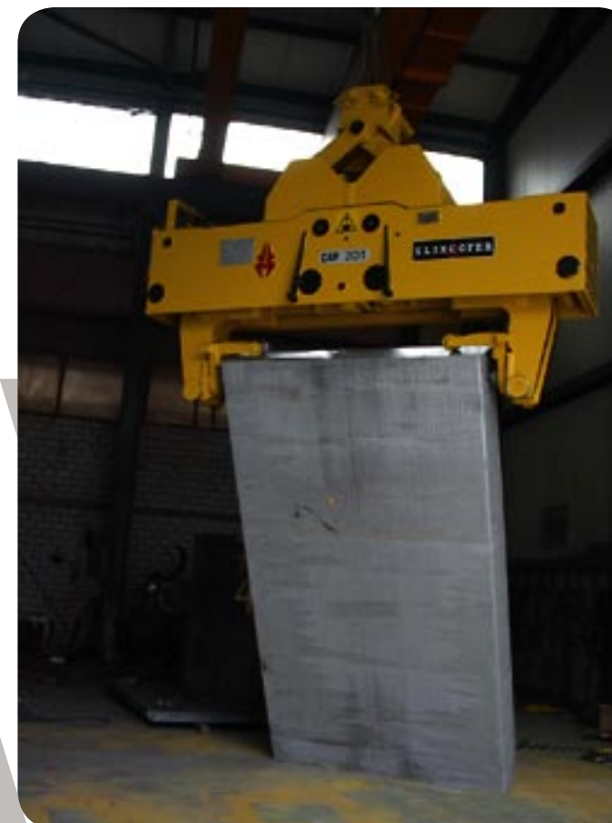
I Pinza automatica meccanica per placche alluminio presa verticale e ribaltamento in orizzontale
