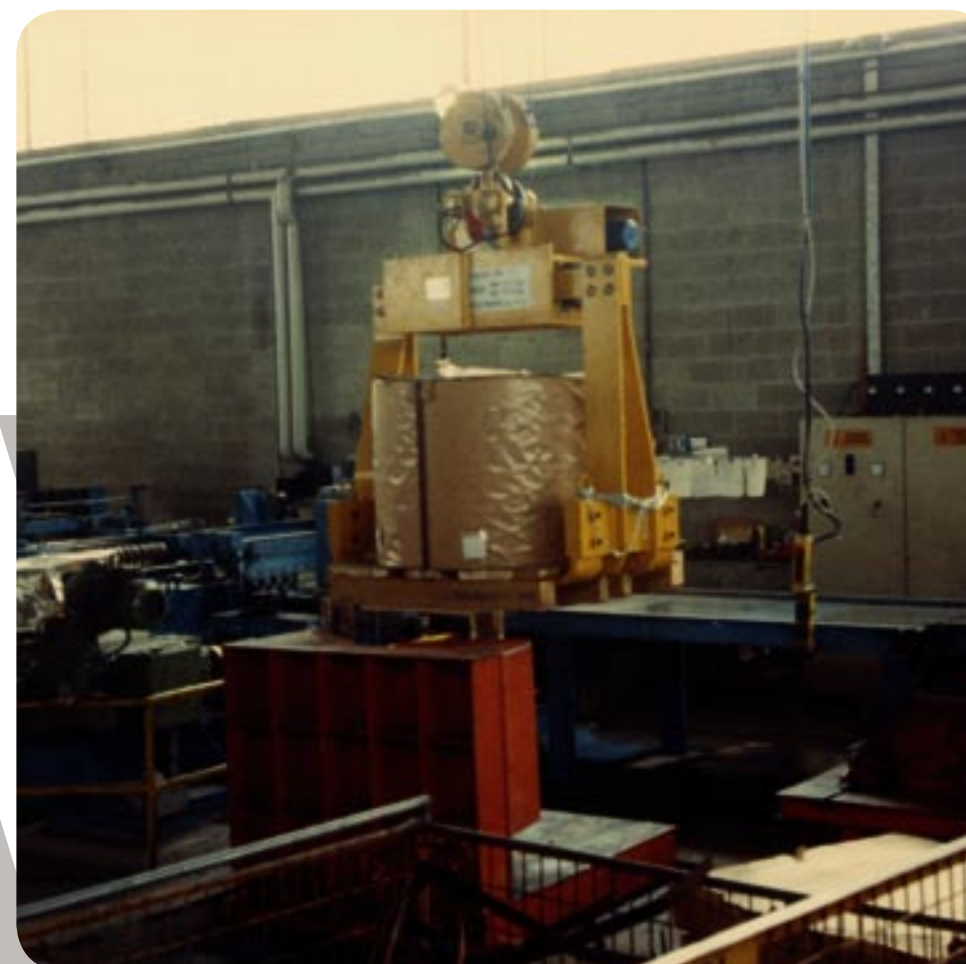
I Pinza motorizzata per coils ad asse verticale su pallets
